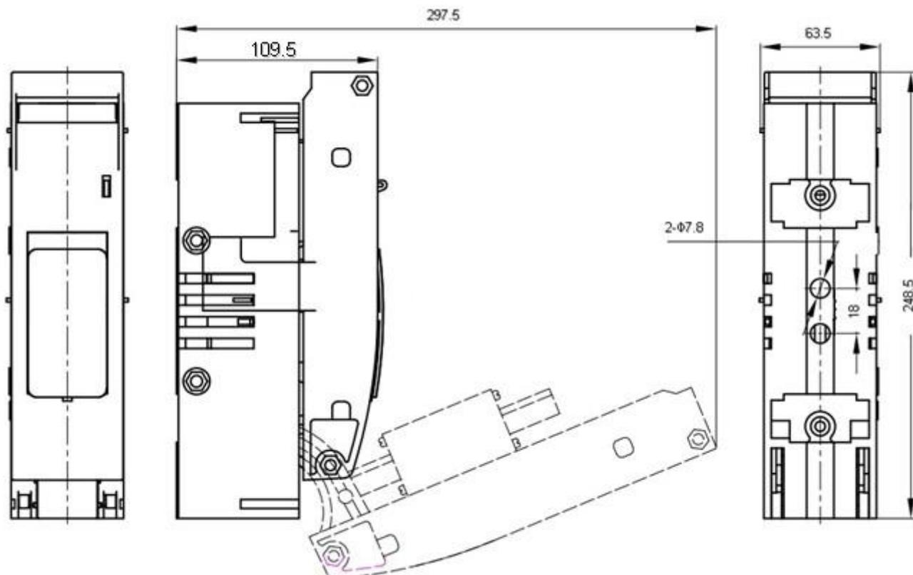
KTL1-1/9-250A型隔离开关单极安装示意图
